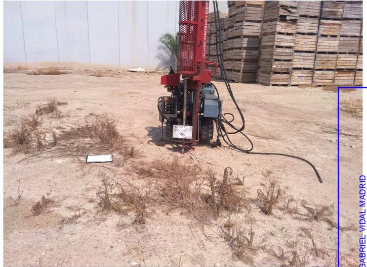
**Fotografías 1 y 2:** Emplazamiento de los ensayos de penetración dinámica DPSH nº1 y nº 2 con puntas de pérdida
