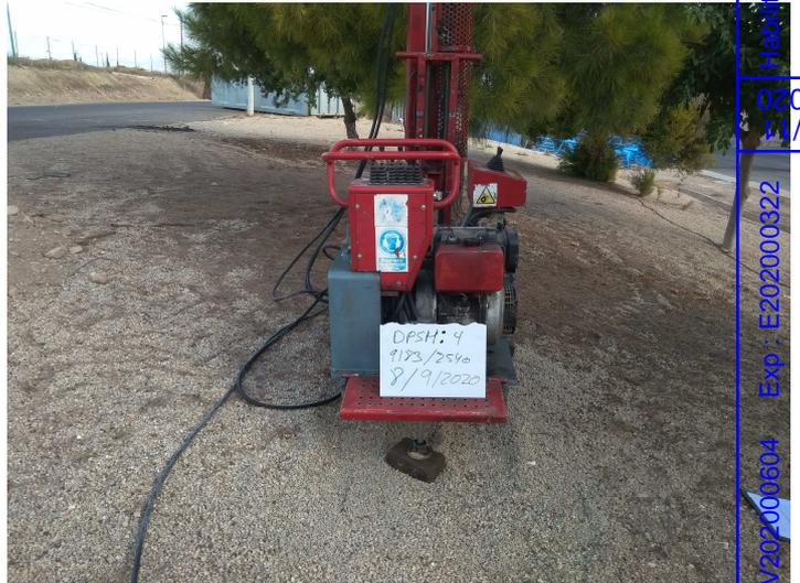
**Fotografías 3 y 4:** Emplazamiento de los ensayos de penetración dinámica DPSH nº3 y nº 4 con puntas de pérdida
